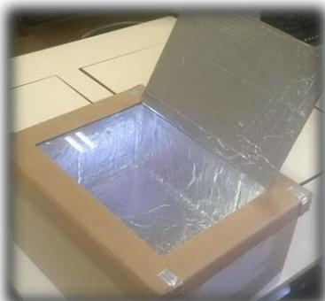
8 - Para fazer o refletor, recorte um retângulo no tampo da caixa, deixando um dos lados por recortar. Cole papel de alumínio numa das faces. Prenda o refletor da tampa à caixa, com fita de velcro.
