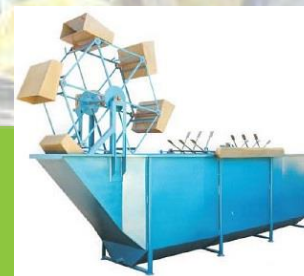
Lavagem e triagem dos plásticos
